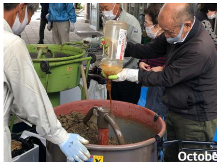
土にBK-1を配合して攪拌し 水質浄化用の担体を製造します
